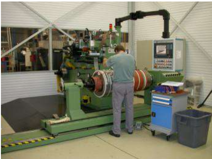
Вставка (проходных изоляторов и отводов)
