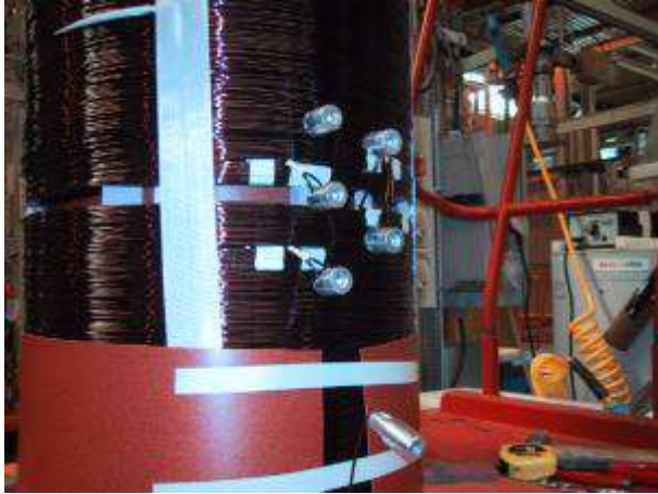
Вставка (проходных изоляторов и отводов)
