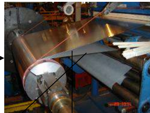
Изготовление обмотки НН
